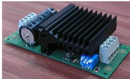
Figura 3.3: Il motor driver MD03
